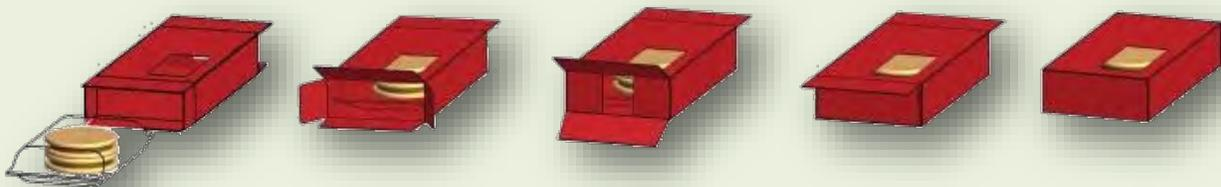
Автоматическое распрямление, заполнение и запечатывание предварительно склеенных складных коробок (горизонтально)
