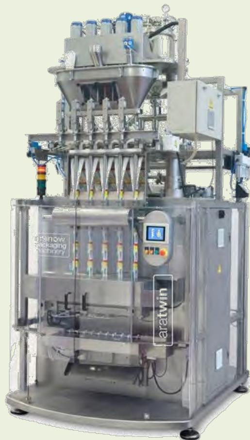
Упаковка двух разных продуктов (жидкость + жидкость, порошок + порошок, жидкость + порошок) в один пакет
