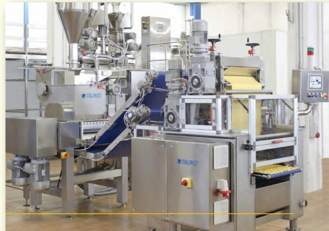
Высокопроизводительная и современная концептуальная установка для производства двухлистных равиоли производительностью до 800 кг/час, полностью автоматизированная, состоящая из: группы подготовки теста, автоматической раскаточной машины с двойной разгрузкой, машины для производства равиоли со сменными формами, дозирующего насоса.
